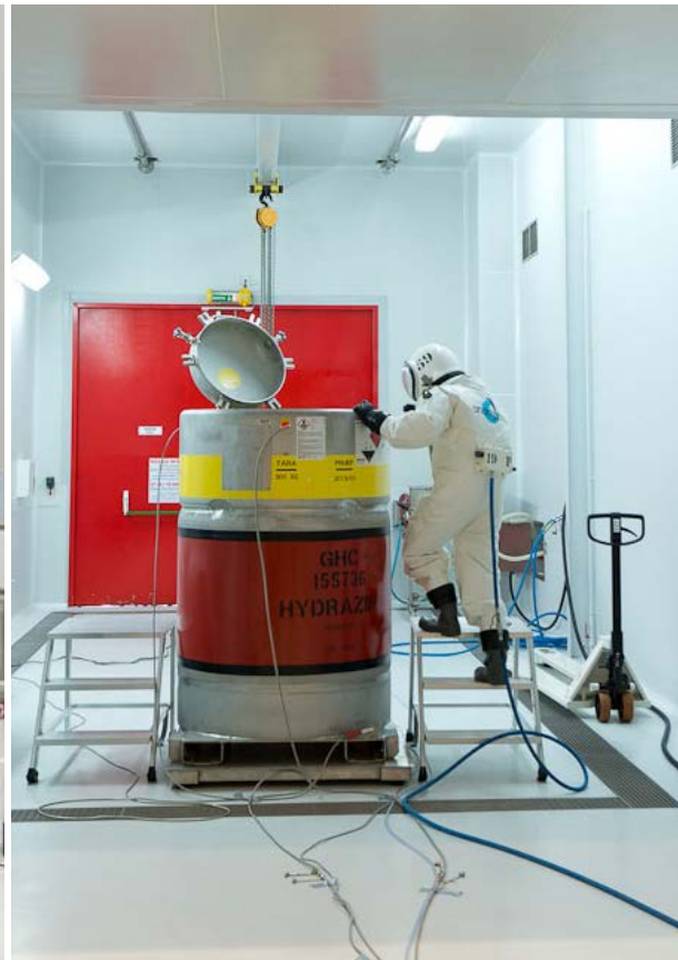
Betankung der Satellitentanks als finale Startvorbereitung in Kourou, Französisch-Guayana
