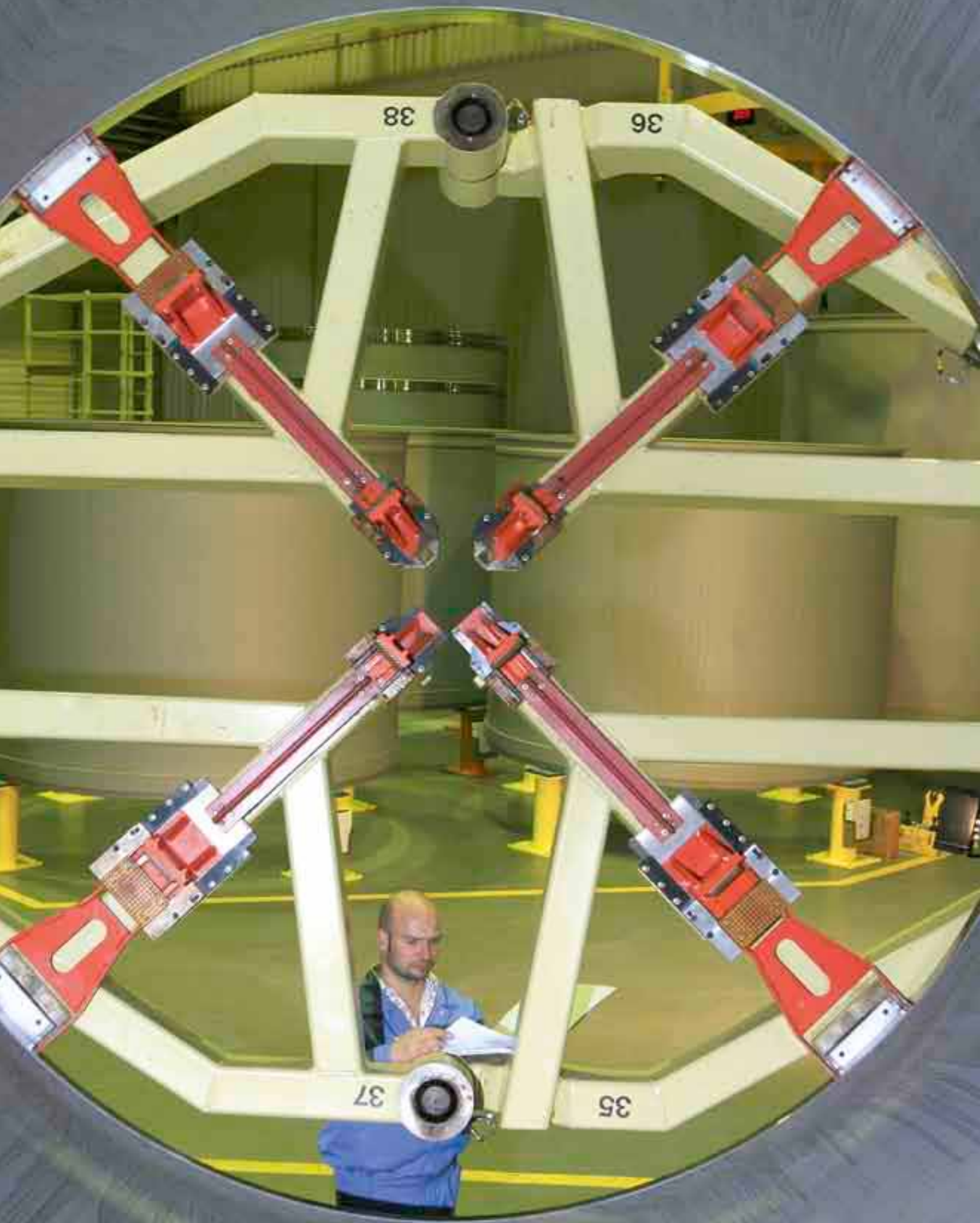
Bearbeitung von allen Seiten: ein Bauteil für die Ariane-Boostergehäuse in der Wendemaschine.
